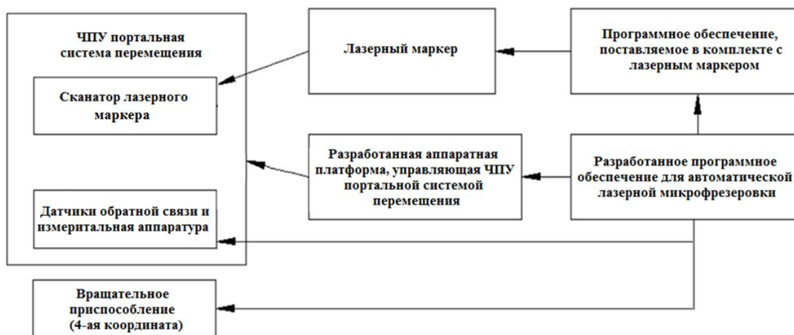
Рисунок 9. Схематичное представление основных узлов и иерархии управляющих сигналов разработанного программно-аппаратного комплекса лазерной микрофрезеровки.
