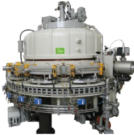
Рис. 1 — Ускоритель Rhodotron TT200.
