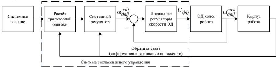
Рис. 3 – Общая структура разрабатываемой системы согласованного управления
