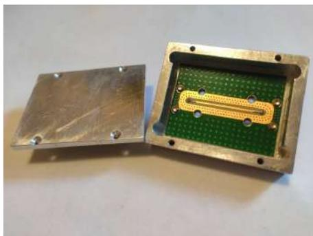
Рис. 2 — Экранированный копланарный волновод (без крышки, лежит рядом), использованный для экспериментов.
