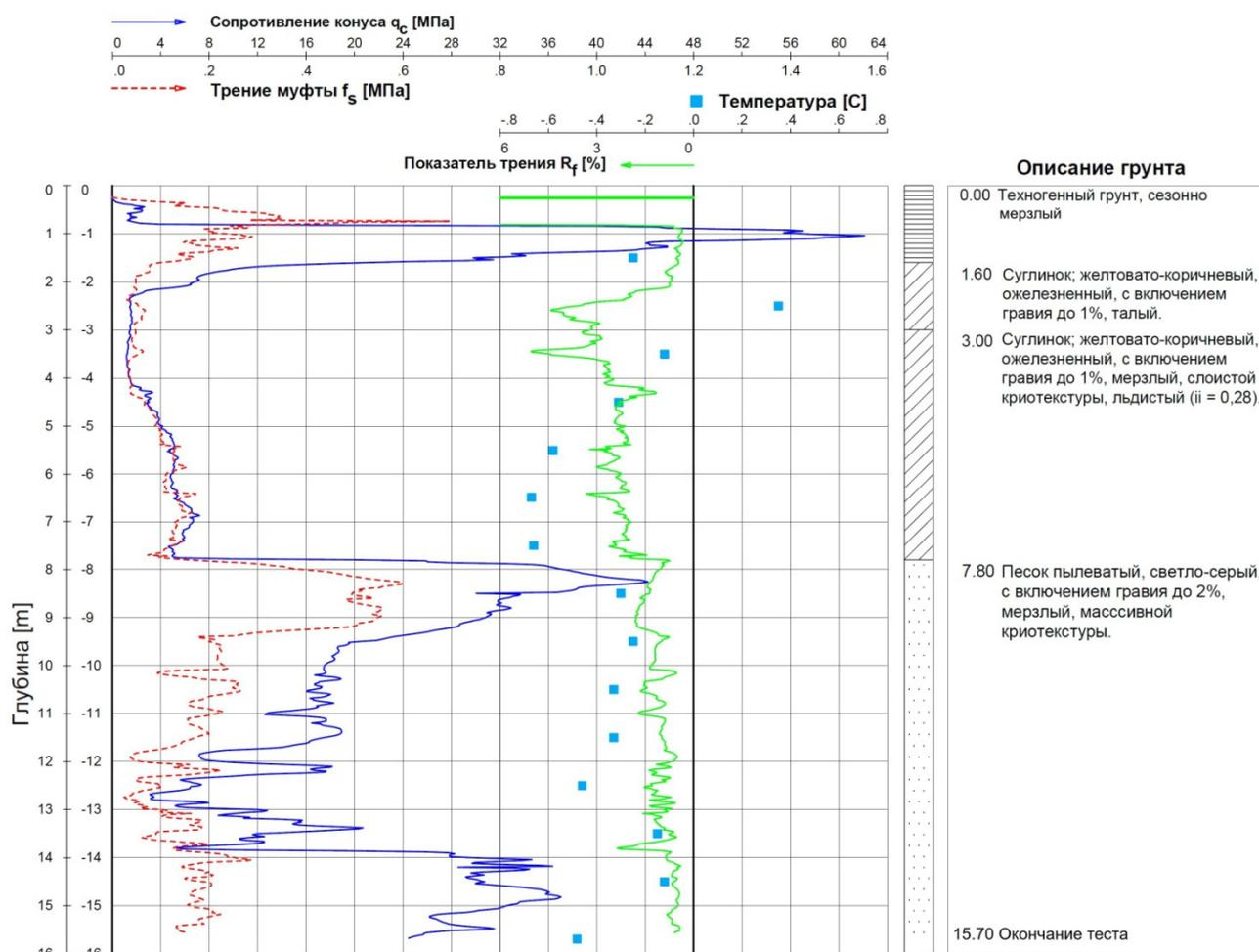
**Рисунок 4 — Литологическая колонка четвертичных отложений в г. Салехард, совмещенная с графиком статического зондирования**
