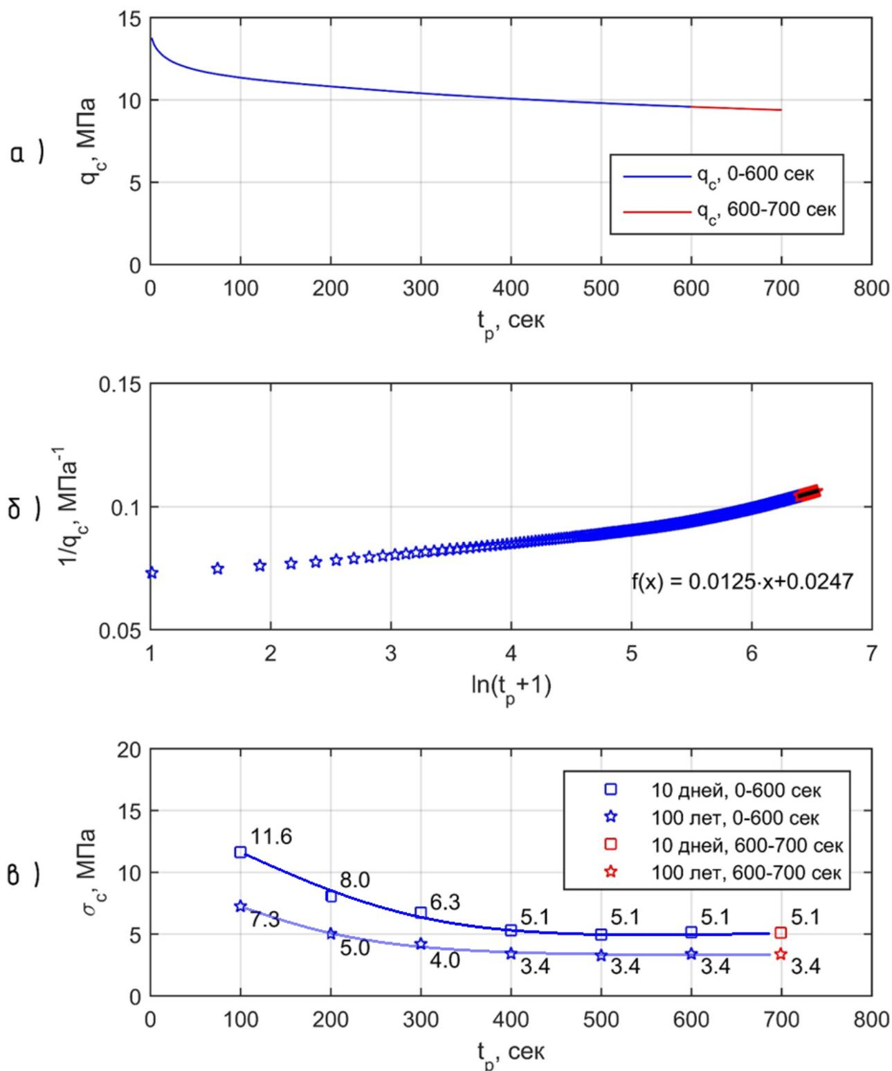
**Рисунок 2 — Пример обработки кривой релаксации лобового сопротивления по предлагаемой методике, где а) — кривая релаксации напряжения; б) — линейзация кривой в обратных и логарифмических координатах; в) — рассчитанные значения длительной прочности**
