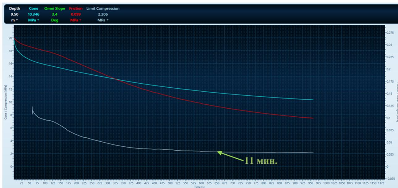
**Рисунок 3 — Пример «опережающей» кривой релаксации лобового сопротивления в полевых условиях по разработанной методике**
