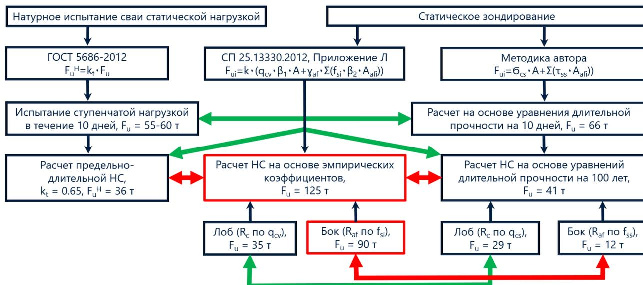
Рисунок 5 — Схема сопоставления результатов расчета несущей способности свай
