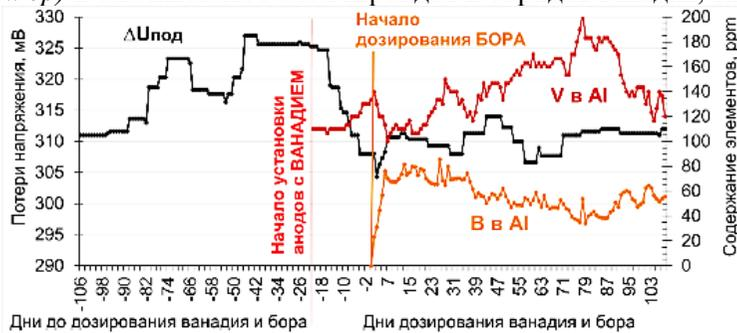
Рисунок 4.2 – Динамика  $\Delta U_{\text{под}}$  и содержания элементов группы 1
