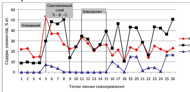
Рисунок 3.4 – EDS-анализы по линии точечных спектров
