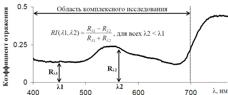
Рис. 1. Спектр отражения листа (на примере гороха) и метод расчета нормализованных индексов отражения при комплексном исследовании индексов отражения.
