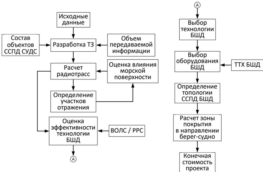
Рисунок 14 – Структура алгоритма применения БШД в ССПД СУДС
