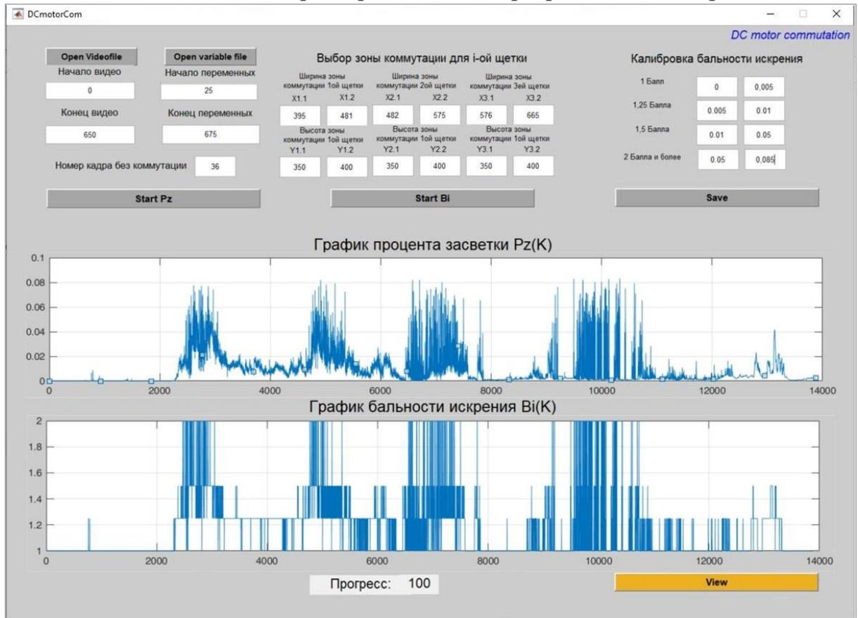
Рис. 6 – Окно программы «DC motor commutation»
