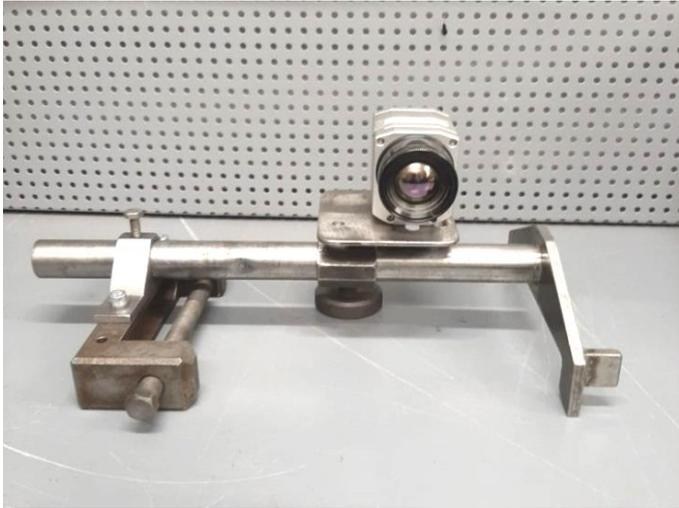
Рис. 4 – Приспособление для закрепления видеокамеры к остову ТЭД
