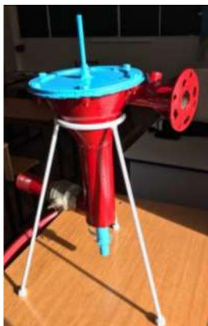
Рисунок 23 – Общий вид саморегулирующегося гидродинамического нагревателя жидкости
