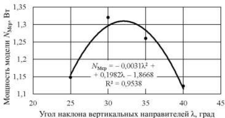
Рисунок 13 – Зависимость мощности модели ротора  $N_{Мср}$  от угла  $\lambda$  плоских вертикальных направляющих
