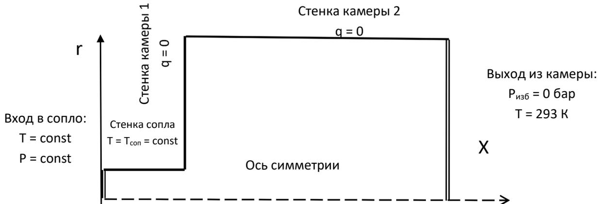
Рисунок 21 - Граничные условия моделирования RESS процесса:
