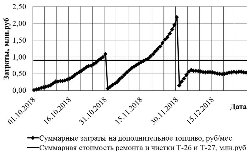
Рис. 11. Сопоставление затрат на ремонт с чисткой и эксплуатации грязных теплообменников
