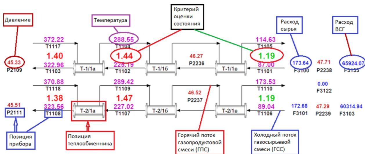
Рис. 5. Фрагмент программы системы контроля состояния сырьевых теплообменников установки гидроочистки ДТ
