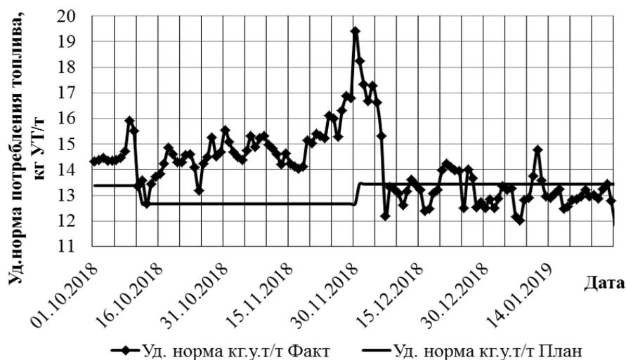
Рис. 10. Удельная норма потребления условного топлива на установке Л-24/9
