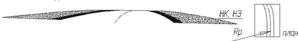
Рисунок 5. Левая кривая, проложенная на выпуклом участке рельефа, при  $R_v: R_p=3,75$ . Возможность дезориентации водителей автомобилей объясняется следующим. Как видно из
