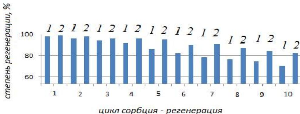
Рисунок 18 – Восстановление адсорбционных свойств АУ марки СКД-515 при 10 циклах сорбция – регенерация: 1–после хлороформа, 2–после трихлорэтилена
