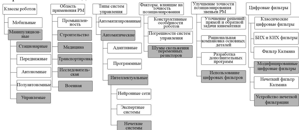
Рисунок 1 – Применение цифровых фильтров в системах управления
