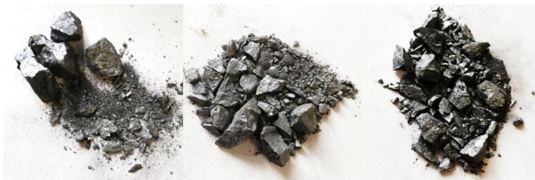
Рисунок 13 – Результаты разрушения образцов ферросплава в одновалковой дробилке с упором на валке с зазором между валком и щекой 26 мм, 20 мм и 13 мм соответственно
