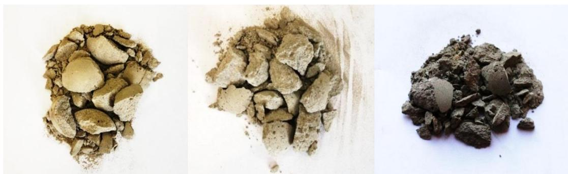
Рисунок 11 – Результаты разрушения образцов в одновалковой дробилке с упором на валке с зазором между валком и щекой 20 мм, 13 мм и 10 мм соответственно
