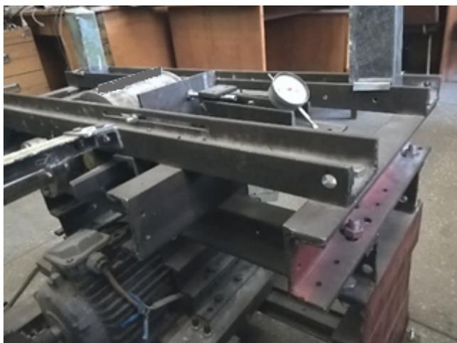
Рисунок 7 – Опытно-экспериментальная установка одновалковой дробильной машины с упором на валке
