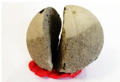
Рисунок 10 – Образец сферической формы после разрушения в одновалковой дробильной машине с упором на валке с установленным зазором между валком и щекой 26 мм
