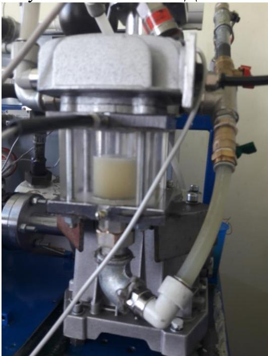
Рисунок 5. Вторая ступень поршневой гибридной энергетической машины с газовым колпаком
