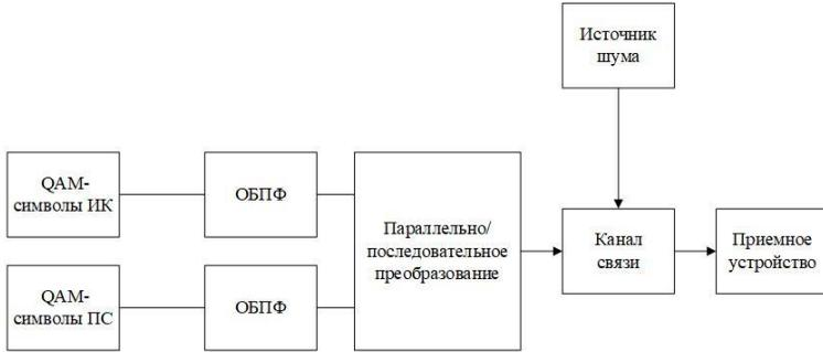
Рисунок 3 – Структурная схема формирования потока OFDM-символов
