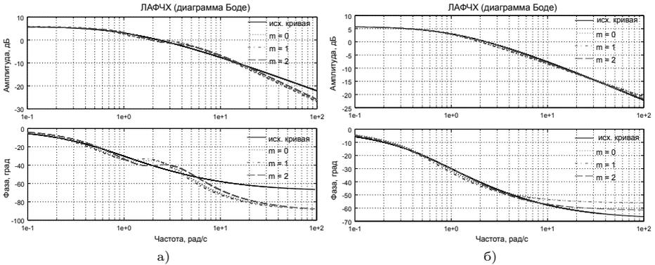
Рис. 11 – Диаграммы Бode: а)  $\gamma^* = 1.66$  и  $\alpha = 0$ ; б)  $\gamma^* = 1.66$  и  $\alpha^* = -0.375$
