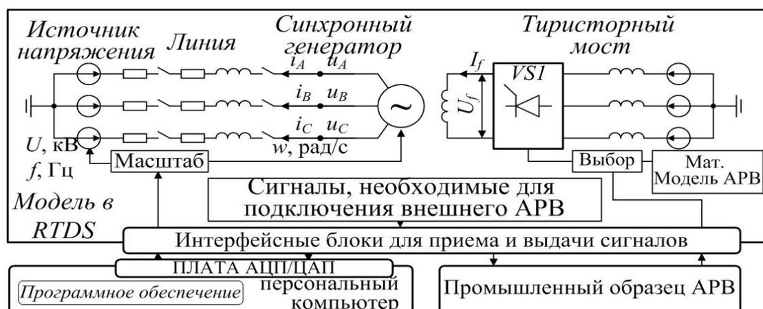
Рисунок 6 – Схема стенда получения экспериментальных частотных характеристик
