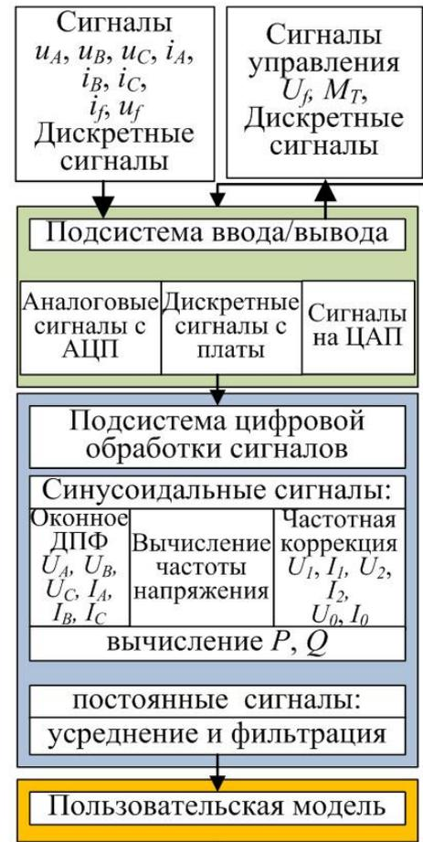
Рисунок 11 – Структурная схема МП средств моделирования
