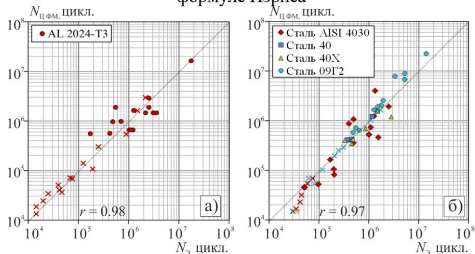
Рис. 9 – Расчет продолжительности роста трещины методом «цикл-за-цикл» по модифицированной формуле Формана-Мэтту
