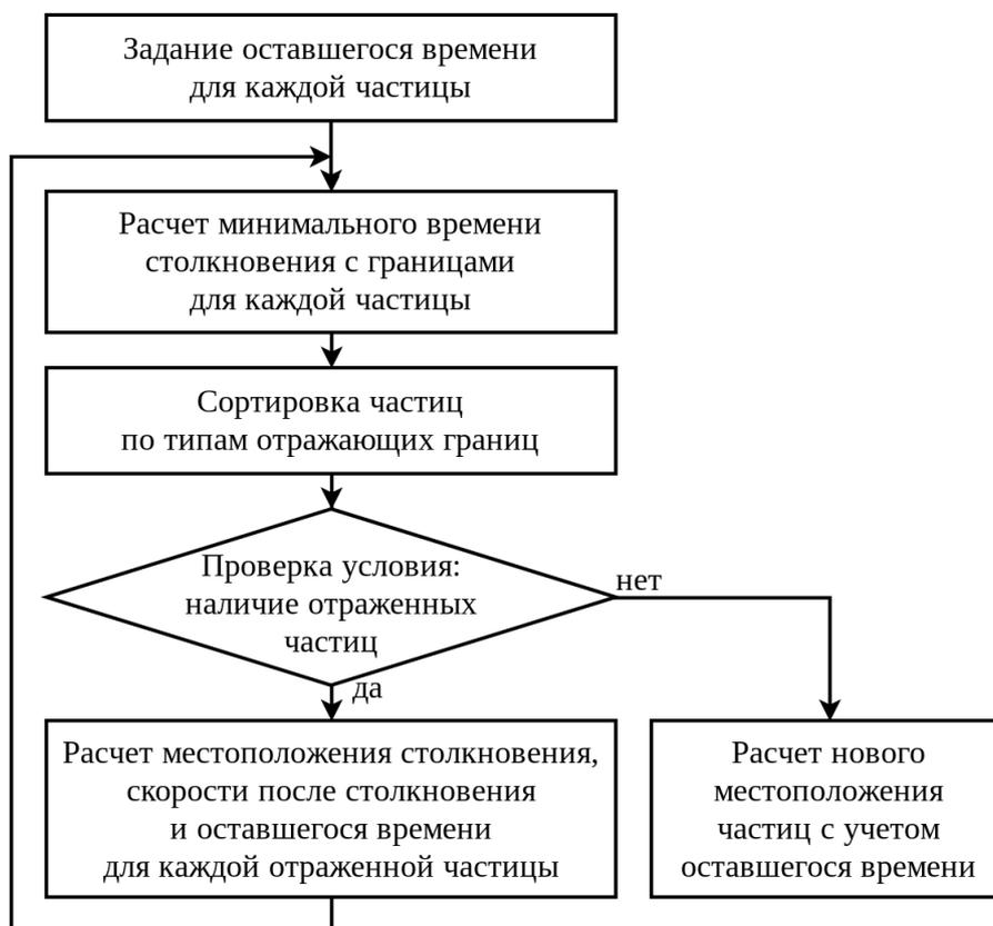
Рис. 4. Схема расчета траектории движения частиц с учетом их возможного взаимодействия с подвижными границами
