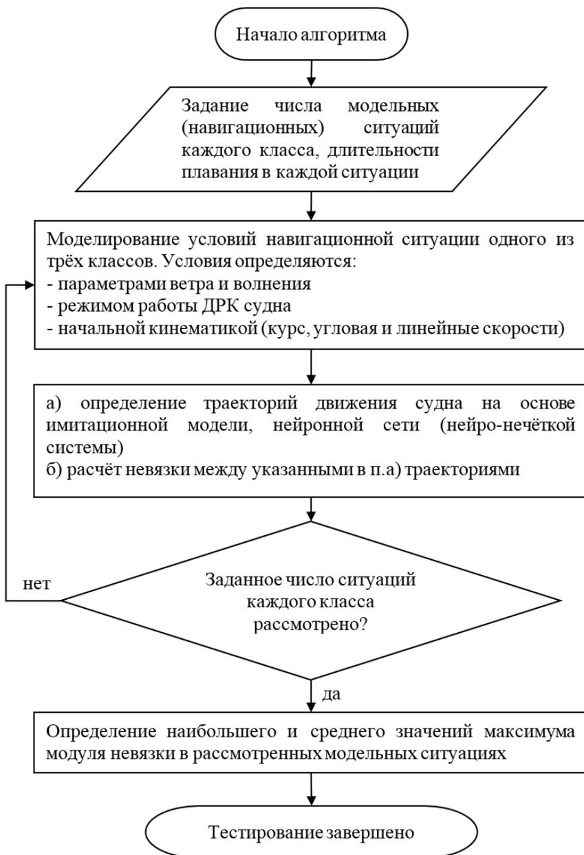
Рисунок 3 — Блок-схема алгоритма тестирования нейросетевых и нейро-нечёткой систем счисления пути судна
