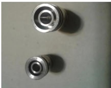
Рис. 1. Корпуса форсунок для испытаний со сменными вставками
