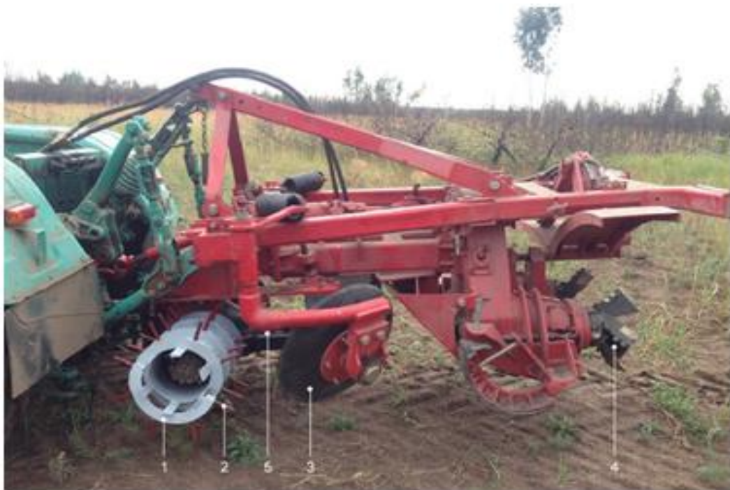
1 – шнековый рабочий орган, 2 – стержневые зубья; 3 – сферические диски; 4 – фрезы-метатели; 5 – гидромотор
