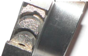
Рисунок 2 - Фрагмент лопаточной детали после интенсивной эрозионно-термической обработки
