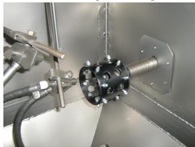
Рисунок 5 – Имитатор вогнутой поверхности с плоскими образцами в камере струйно-динамической установки
