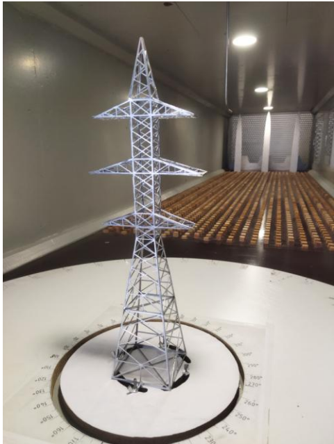
Рисунок 15 - Модель опоры У 220-2+9 в рабочей части аэродинамической трубы МАТ-1: а) без имитации проводов и троса; б) с имитацией проводов и троса.
