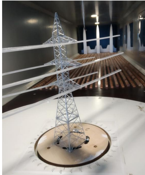
Рисунок 15 - Модель опоры У 220-2+9 в рабочей части аэродинамической трубы МАТ-1: а) без имитации проводов и троса; б) с имитацией проводов и троса.
