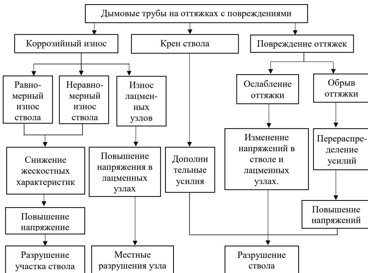
Рисунок 13 – Влияния выявленных повреждений на несущую способность дымовых труб с оттяжками
