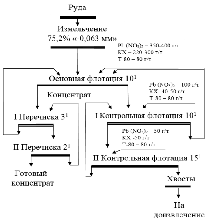
Рисунок 1 – Рекомендуемая схема флотации руды нижних горизонтов Джижикрутского месторождения
