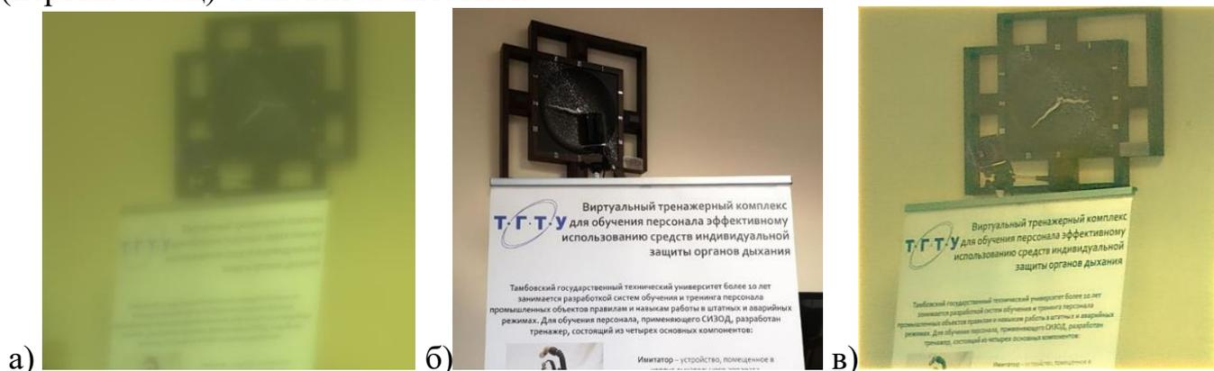
*Рисунок 1 – Примеры изображений реальной сцены, полученные: а) изображающей дифракционной оптикой, б) рефракционной оптикой, в) в результате нейросетевой реконструкции изображения а)*
