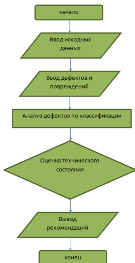
Рисунок 7 – Блок-схема алгоритма диагностики объектов инфраструктуры нефтехимических предприятий
