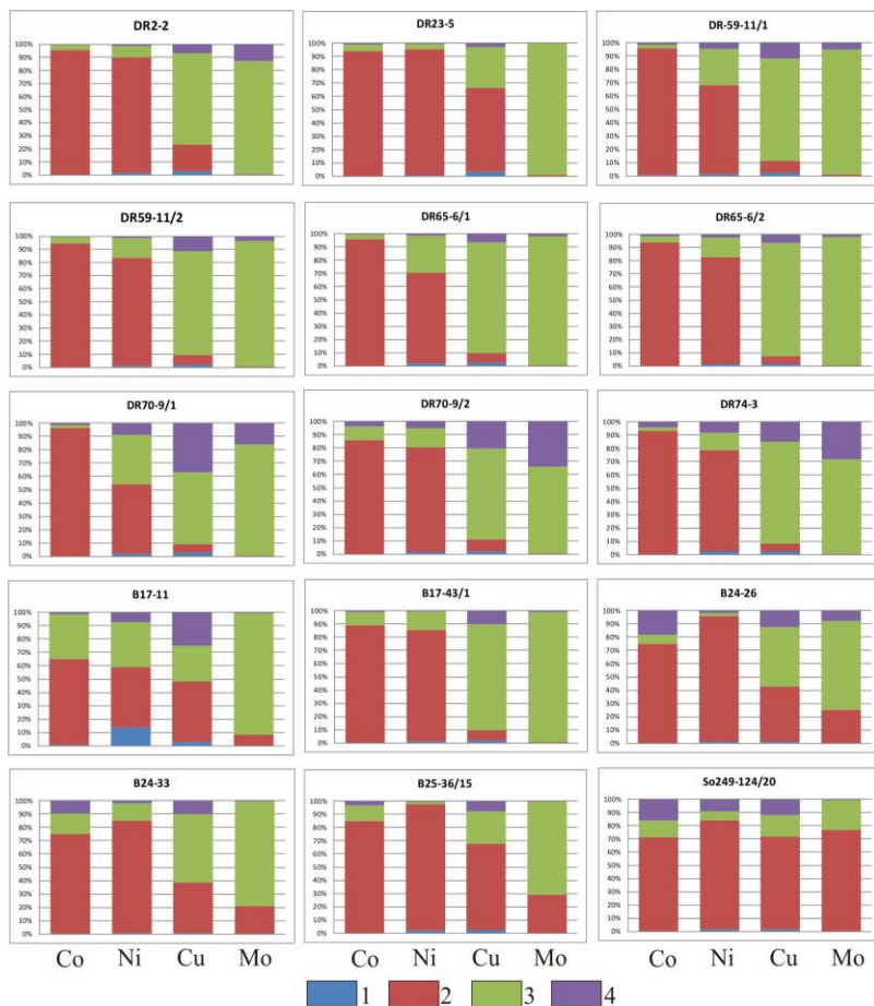
Рис. 9. Процентное соотношение содержаний кобальта, никеля, меди и молибдена в железомарганцевых корках северной Пацифики. DR2-2 – P3 Амлия; DR23-5 – P3 Пат; DR57-9/1, DR57-9/2, DR59-11/1, DR59-11/2 – P3 Стейлмейт; DR65-6/1, DR65-6/2 – гайот Детройт; DR70-9/1, DR70-9/2 – гайот Ханзей; DR74 – гайот Сьюзей; B17-11 – вулк. Обручева, КОД; B17-43/1 – вулкан 7.14, КОД; B24-26 вулк. Миронова, КОД; B24-33 – вулк. Макарова, КОД; B25-36/15 – вулкан 3.19; So249-124/20 – массив Вулканологов, Берингово море.
