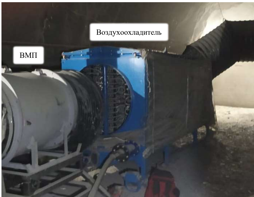
Рисунок 10 — Система кондиционирования воздуха, применяемая в выработке
