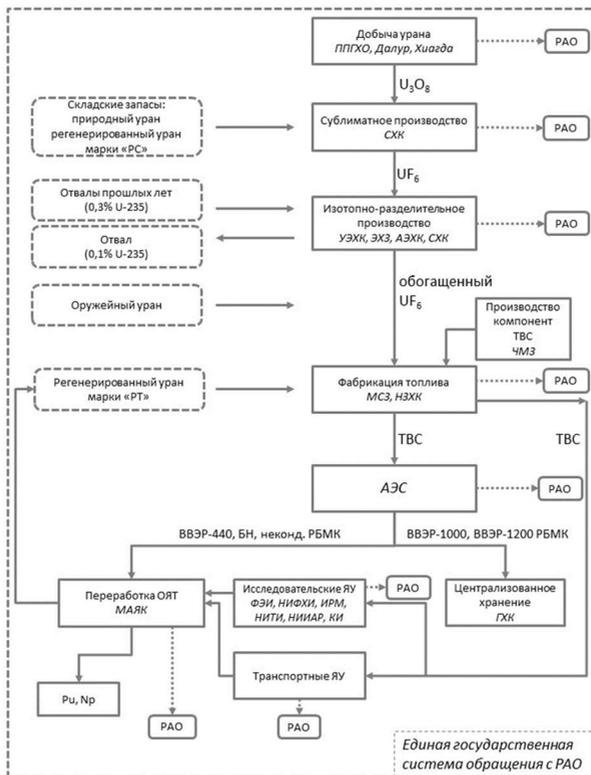
Рисунок 1 – Принципиальная схема ЯТЦ, включающего в себя предприятия АЭПК
