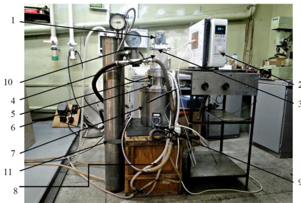
Рисунок 6 - Фотография экспериментального СВЧ - реактора: 1 – промышленный 2.45 ГГц / 1 кВт магнетрон; 2 – система сетевого питания; 3 – система воздушного охлаждения магнетрона; 4 – согласующие волноводные элементы; 5 – барьерное окно; 6 – волновод связи; 7 – рабочая камера реактора; 8 – система водяного охлаждения реактора; 9 – термопара; 10 – манометр; 11 – теплообменник для охлаждения газов, выходящих из реактора
