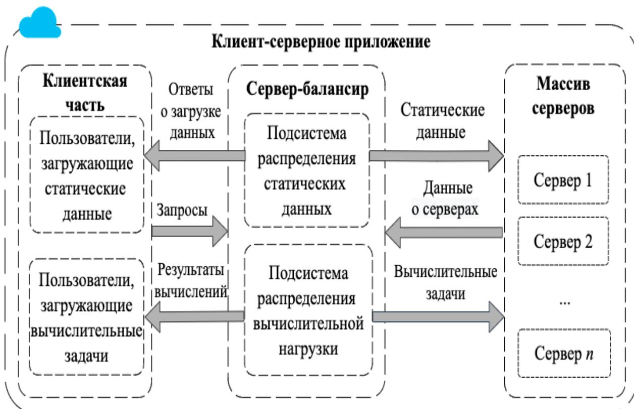
Рисунок 1 – Схема клиент-серверного приложения с балансиром нагрузки.
