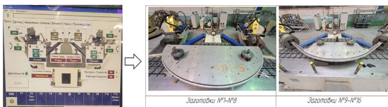
Рисунок 9 – Внешний вид деформированных заготовок на прессе V-80
