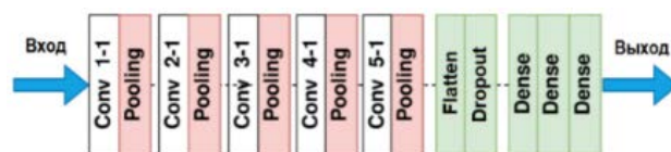
Рисунок 2 – Архитектура сверточной нейронной сети
