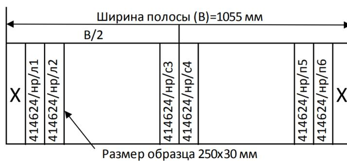
Рисунок 2 – Схема разделки проб ЭАС для испытаний на разрыв: нр – начало рулона; ср – середина рулона; кр – конец рулона; л – левая кромка; с – середина; п – правая кромка
