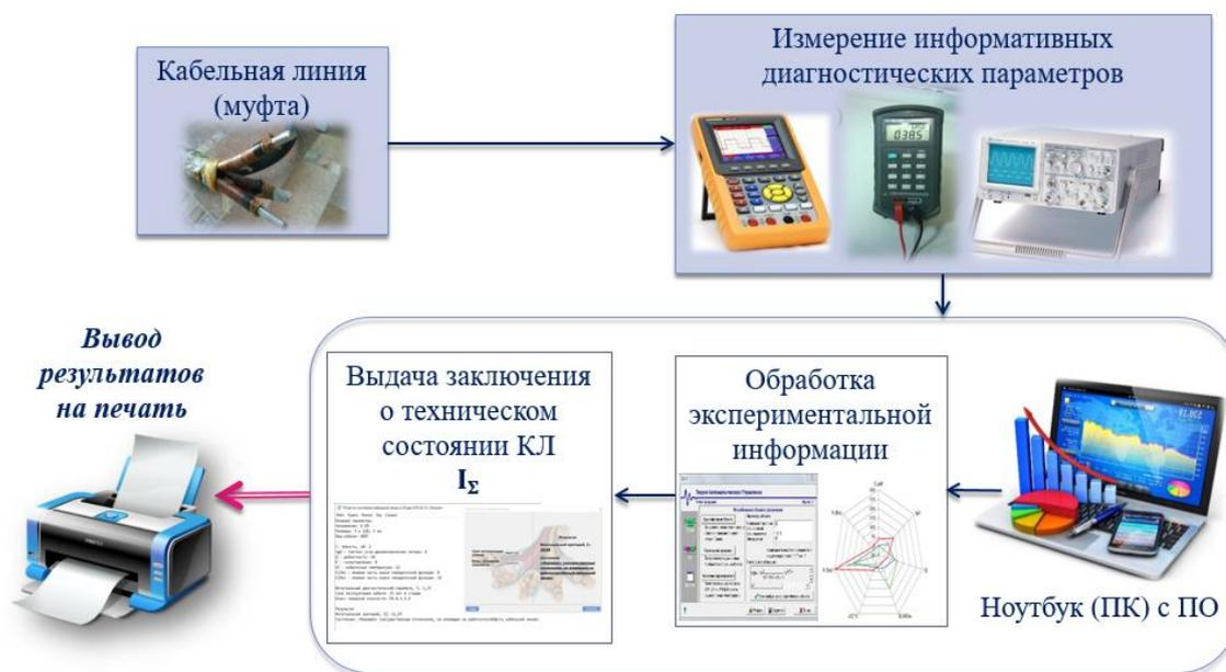
Рисунок 9 – Структурная схема комплекса для установления состояния КЛ
