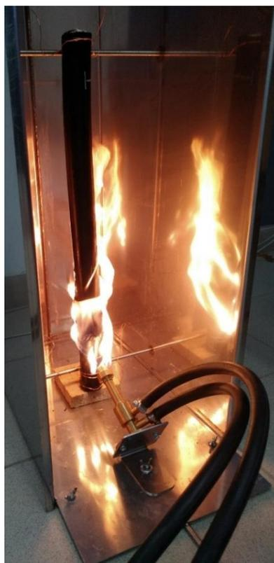
Рисунок 6 – Воздействие пламени на кабель ААШв во время испытаний
