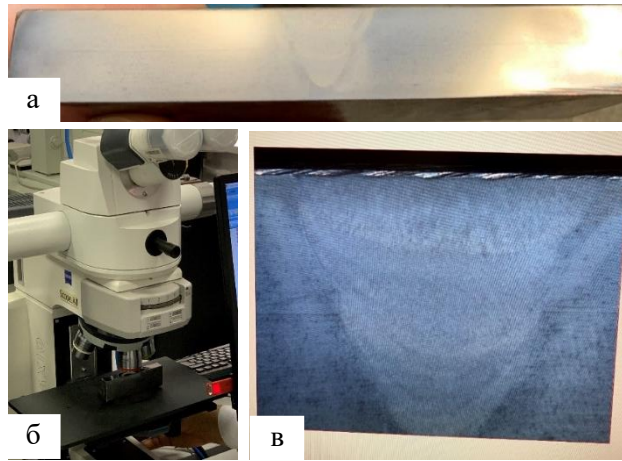
а) образец протравленного образца сварного соединения; б) инвертированный микроскоп; в) структурная неоднородность сварного шва на увеличении 200х
