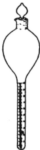
Рисунок 15– Колба Сазерленда для определения содержания воды
