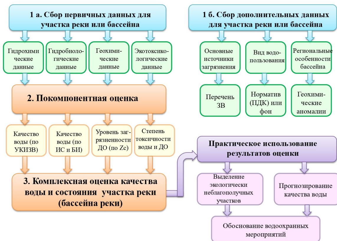
Рисунок 9 – Концептуальная блок-схема проведения комплексной оценки качества воды и состояния водной среды участка реки или речного бассейна (обозначения на схеме: УКИЗВ – удельный комбинаторный индекс загрязненности воды, ИС – индекс сапробности (по фито- или зоопланктону), БИ – биотический индекс (по макрозообентосу), ДО – донные отложения, ЗВ – загрязняющие вещества)
