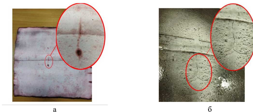
Рисунок 9 – Фотография выявленной разветвленной трещины в области сварного шва: а) цветная дефектоскопия, б) магнитно-порошковая дефектоскопия
