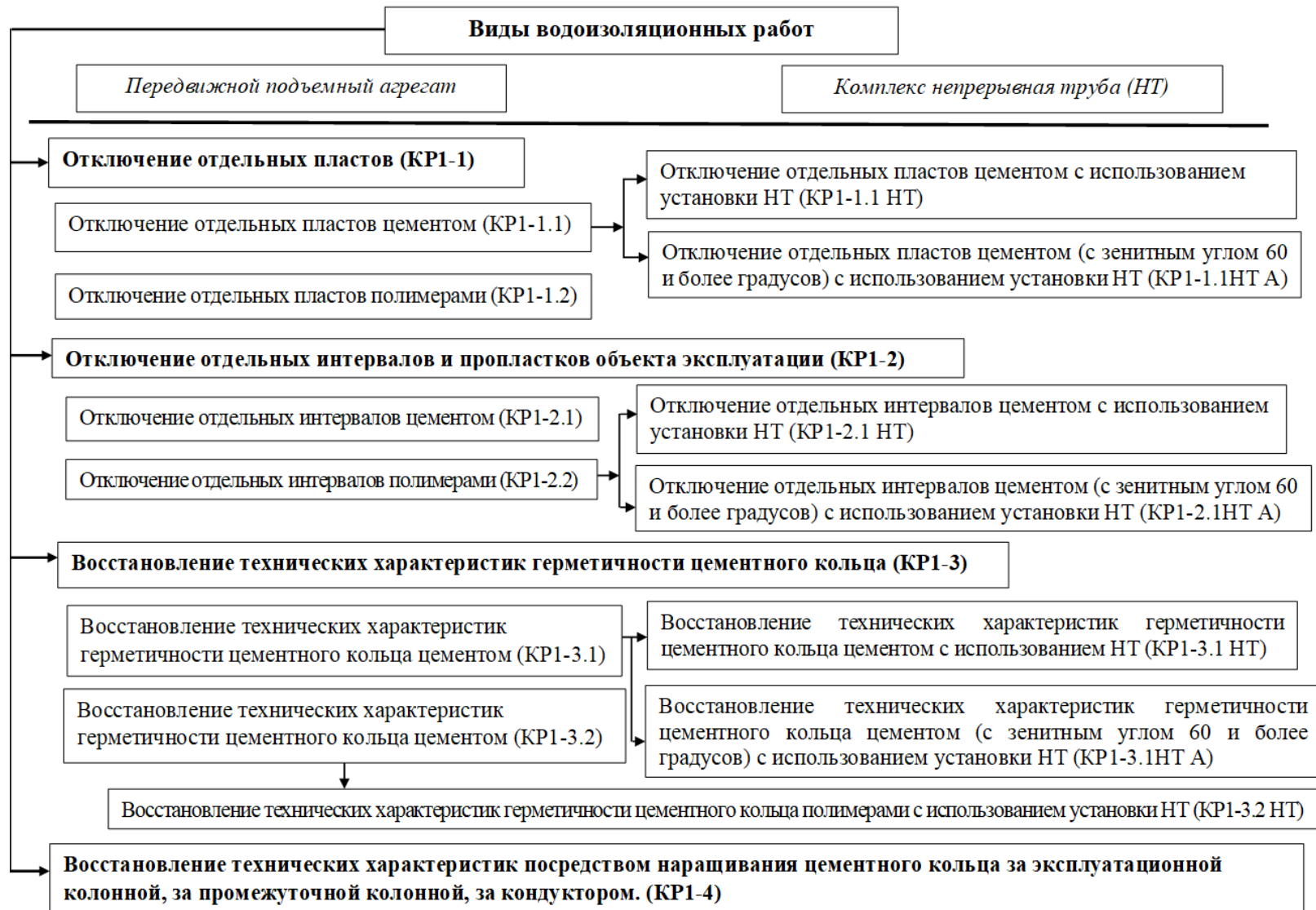
Рисунок 5 – Классификация видов водоизоляционных работ в газовых скважинах в зависимости от вида наземного оборудования
