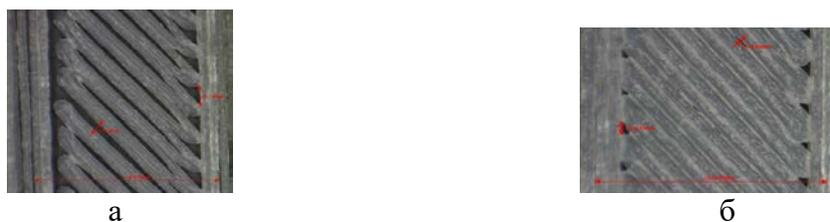
Рисунок 5 – Фотоизображение первого слоя FDM печати образцов с микроскопа: а) первый слой FDM печати образца со стандартными настройками; б) первый слой FDM печати образца с коэффициентом потока  $K_F = 115\%$
