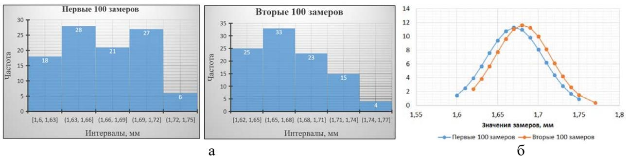
Рисунок 3 – Результаты статистической обработки проведенных замеров: а) гистограммы частот появления значений замеров диаметра прутка филамента; б) график Гаусса-Лапласа
