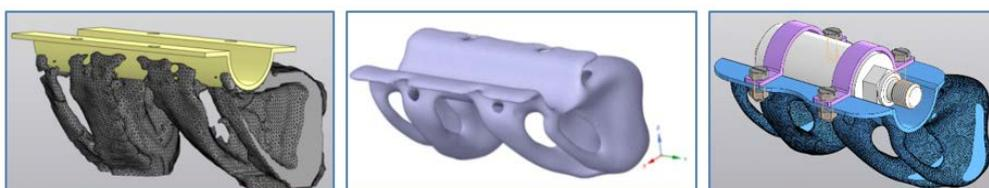
Рисунок 9 – Моделирование соединительного узла в САПР КОМПАС-3D v12
