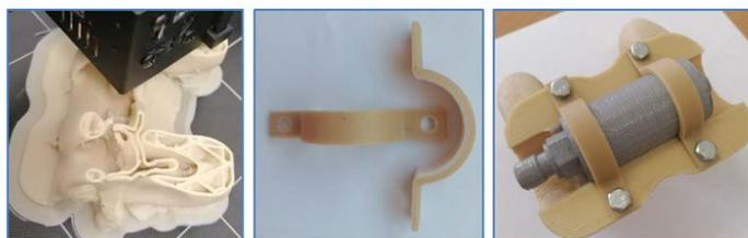
Рисунок 10 – FDM 3D-печать кронштейна и хомутов соединительного узла
