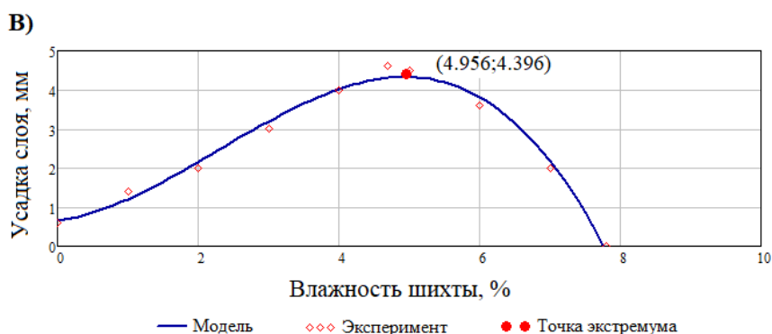
Рис. 2. Влияние влажности шихты \omega (%) на: А) насыпную массу d (кг/дм 3 ); Б) скорость перемещения зоны сушки \vartheta_1 (м/сек); В) усадку слоя \Delta h (мм)
