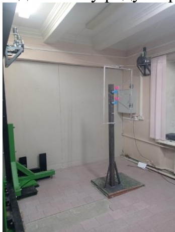
Рис. 10. Внешний вид лабораторно-исследовательского стенда по 4-х тросовому обезвешиванию.
