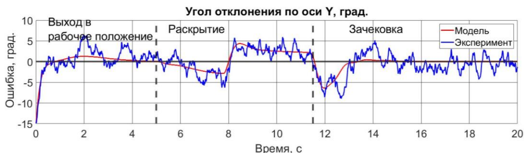
Рис. 11б. Переходные процессы работы системы активного 4-х тросового обезвешивания по ошибке отклонения по оси Y.
