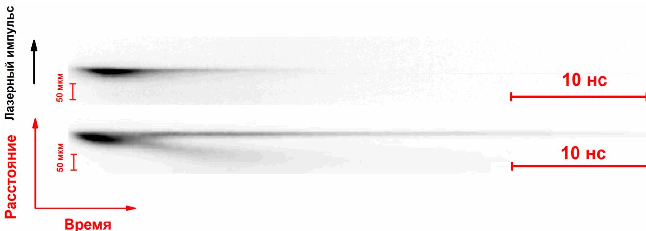
**Рис. 3.** Изображение стрик-камеры, демонстрирующее эволюцию плазмы оптического пробоя с течением времени: оптический пробой, произошедший на индивидуальной наночастице (сверху), оптический пробой, произошедший на двух близко расположенных наночастицах (снизу).
