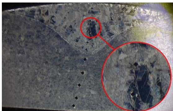
Рис. 13. Схема измерения твердости при исследовании ЗТВ
