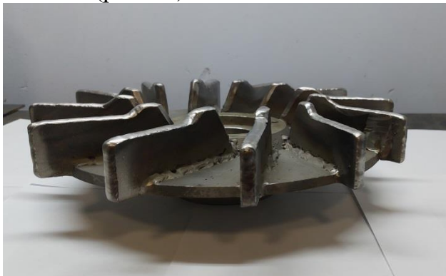
Рис. 23. Внешний вид наплавленного рабочего колеса насоса 1X-80-50-200А-ТЛ-55
