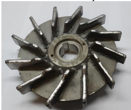
Рис. 23. Внешний вид наплавленного рабочего колеса насоса 1X-80-50-200А-ТЛ-55
