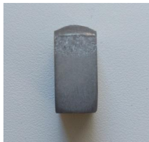
Рис. 21. Поперечное сечение валика наплавленного с применением медных формирующих пластин
